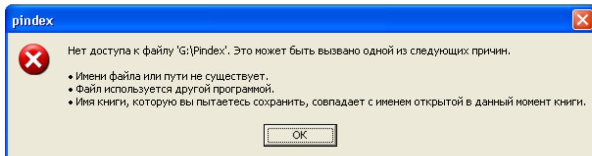
Причина в том, что программа пытается сохранить файл результатов в том же каталоге, из которого была запущена. Для устранения ошибки следует или снять защиту от записи с внешнего носителя или скопировать программу на жёсткий диск компьютера и запускать оттуда.
